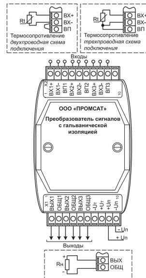
Схема подключения преобразователя PSA-01.07.14.XXXX.XX
