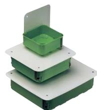
Разветвительная коробка для полых стен, жаропрочная, для стен толщиной 7 - 35 мм, с белой крышкой
