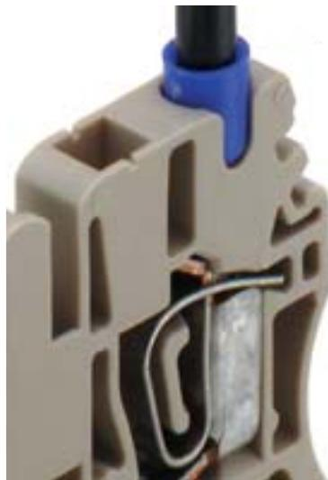
Клетка пружинной клеммы выполнена с запасом по максимальному сечению провода и габаритам изолированного кабельного наконечника, что снижает стоимость и повышает компактность монтажа. Запас по сечению позволяет зажимать в клемму провод с обжатым изолированным кабельным наконечником без снижения максимального значения сечения подключаемого провода.
