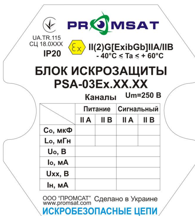
Рис. 5.1 Маркировка блока искрозащиты серии PSA-03Ex.
